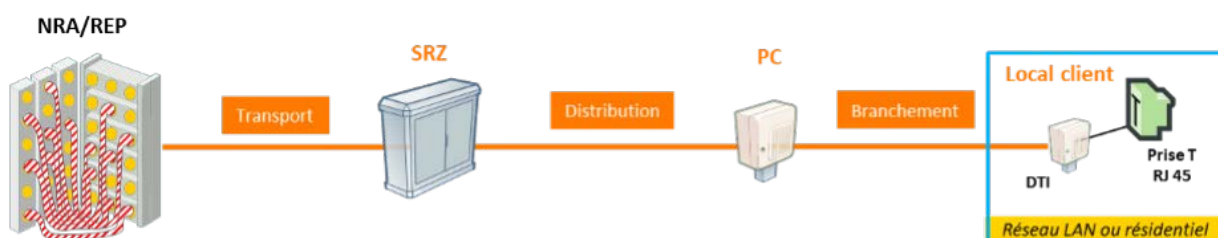
Synoptique d'une boucle locale cuivre (source Cazes-conseil)
